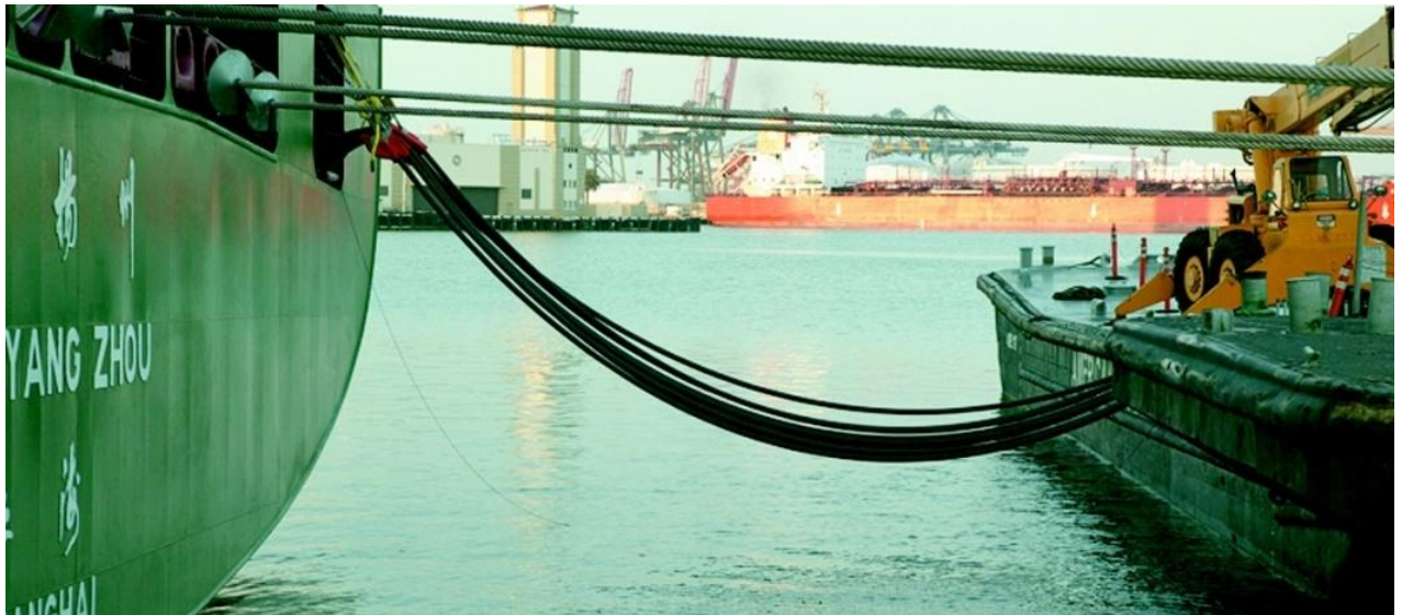
Εικόνα 5.1 Σύνδεση καλωδίων πλοίου από τη στεριά[4].
